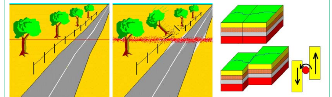
Una faglia è la materializzazione della superficie lungo cui avviene la rottura della roccia.
